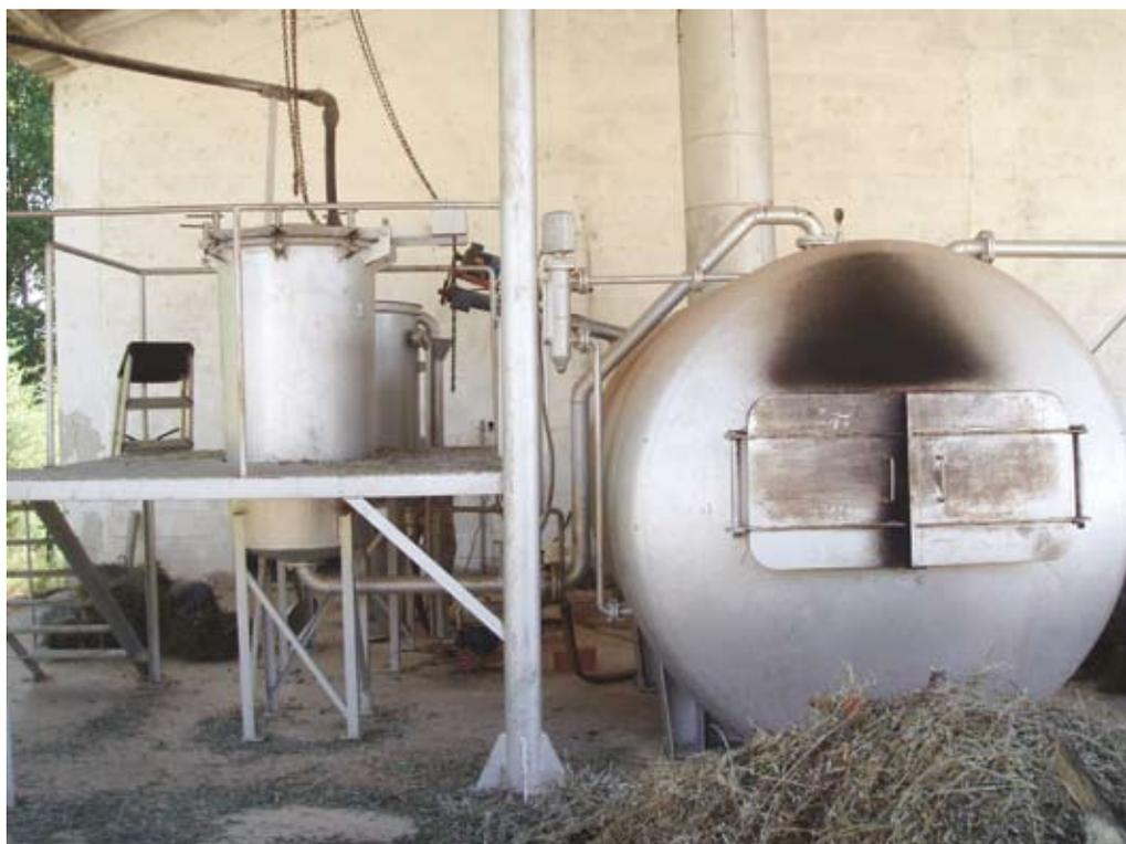
**Figura 1:** Destiladora y proceso de destilación tradicional por arrastre de vapor de plantas aromáticas en la Serranía de Cuenca.
